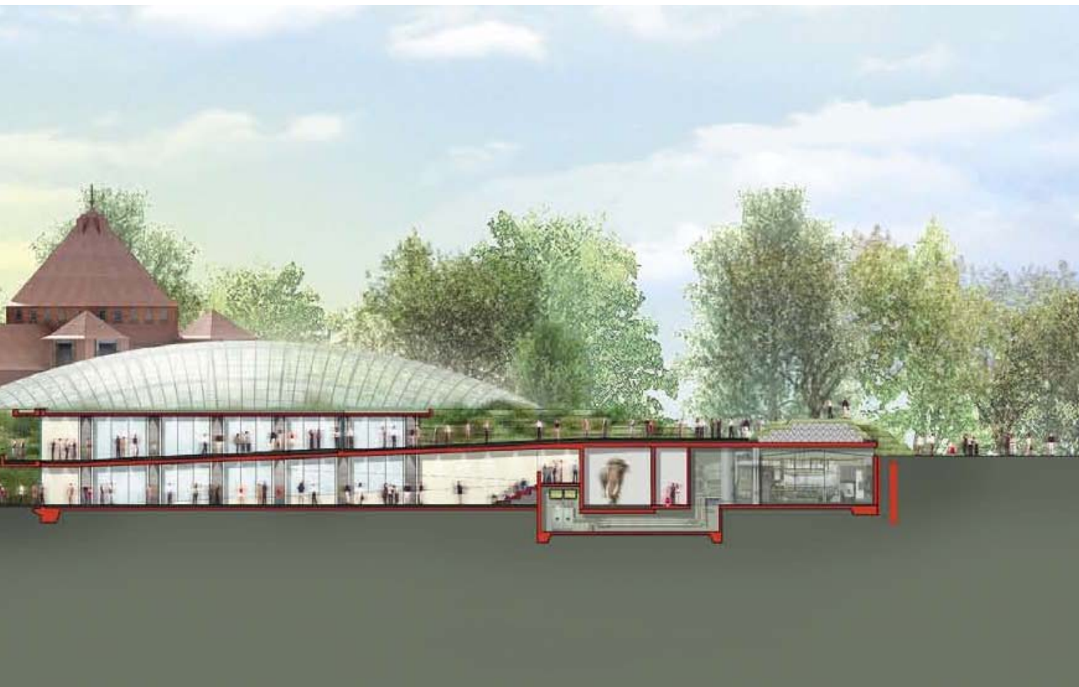
Elefanthuset opføres i en betonkonstruktion på ca. 3.000 m 2 med 2 stål-/glaskupler på hhv. ca. 800 og 400 m 2 samt tilhørende udeanlæg på ca. 4.000 m 2 .
